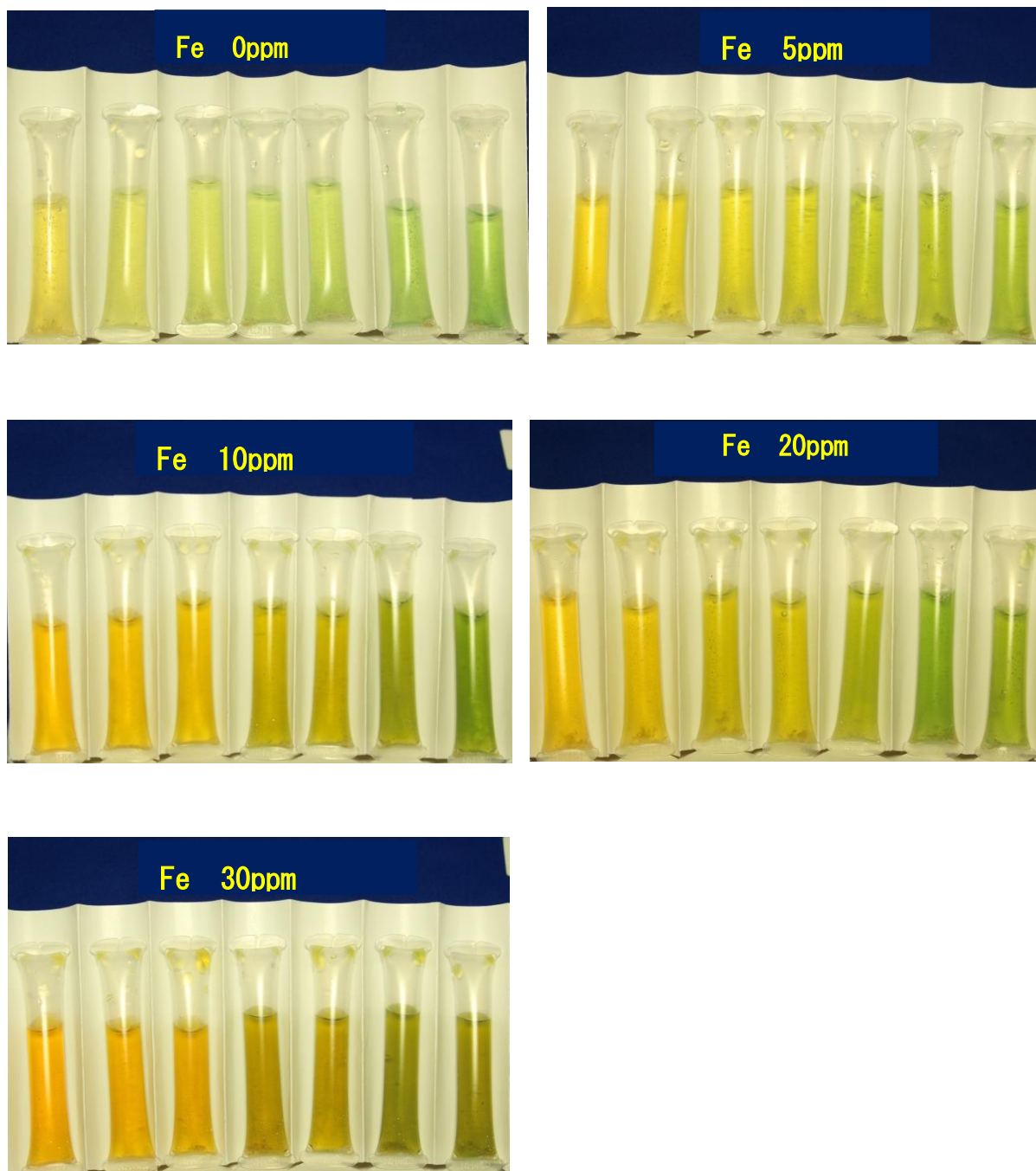
図 13 鉄イオン共存下でのアンモニア態窒素の比色
