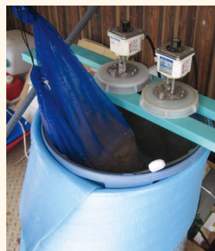
E M 活性装置のヒーターを使い、種籾の温湯処理を行う
