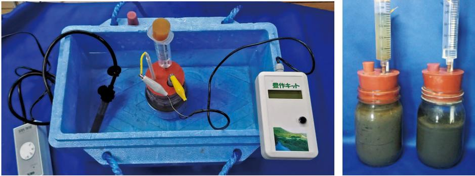
写真2 土壌診断キット：還元度（Eh=酸化還元電位）測定とガス発生量測定の様子
