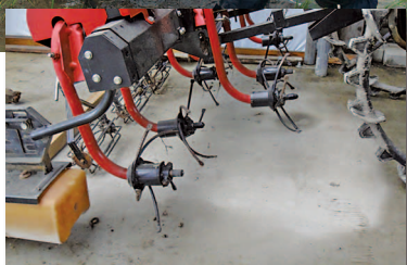
陽一さんが操るのはキュウホーを搭載した乗用除草機10aを約15分で回り、全水田面積46haを2回除草する
