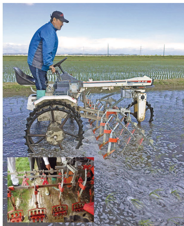
陽一さんが操るのはキュウホーを搭載した乗用除草機10aを約15分で回り、全水田面積46haを2回除草する
