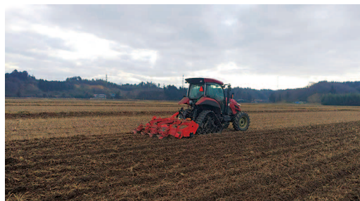
畝立てで土の乾燥を促すことにより、塊茎雑草繁殖を抑え、稲わら分解を進める二山耕起
